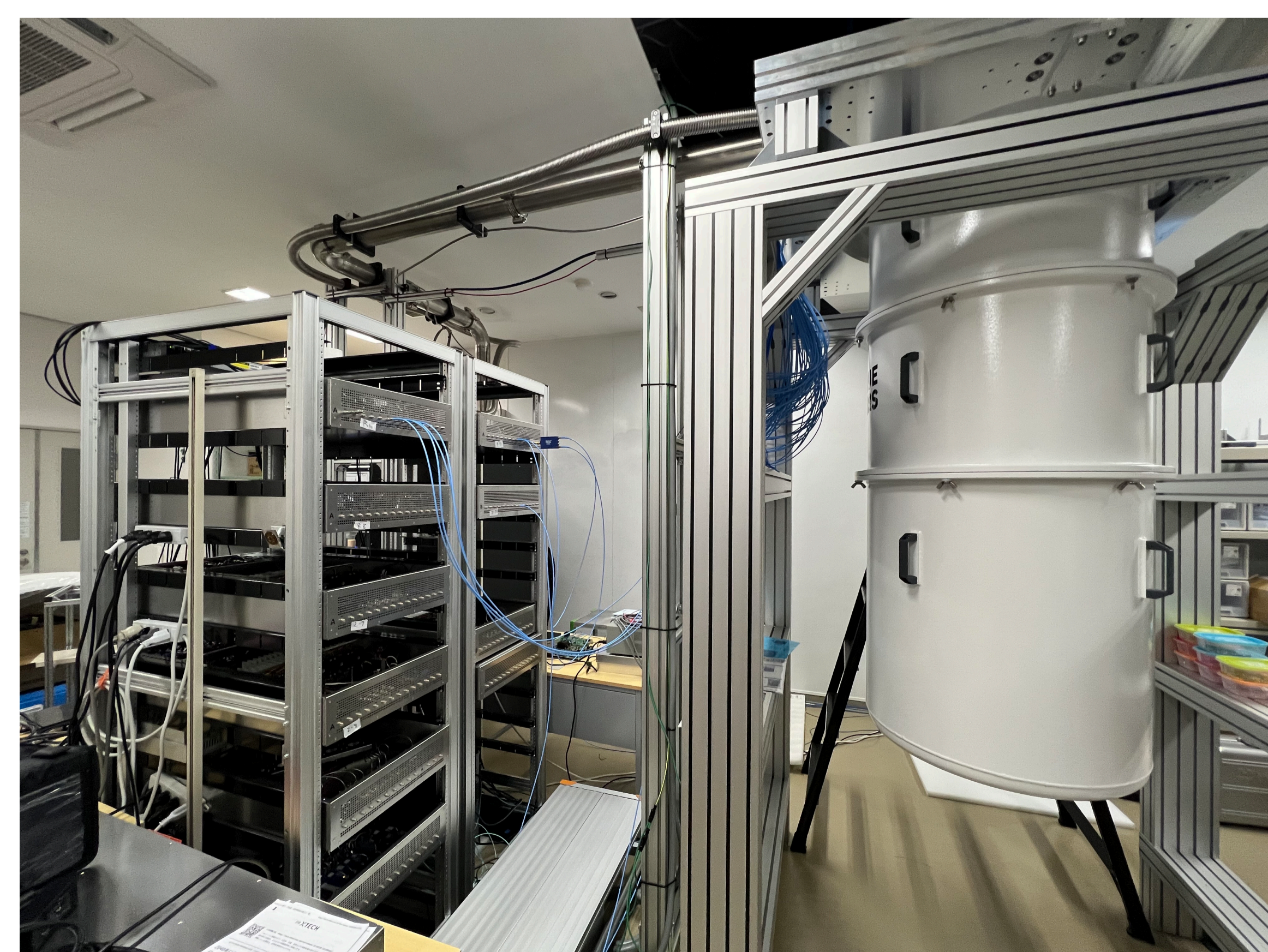
大阪大学での量子コンピュータ制御実験の環境 (複数台の制御装置を量子ビットに接続し、多量子ビットの制御実験を実施中)
